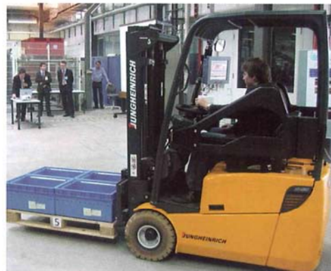
Im Boden eingelassene RFID-Transponder sorgen für die Ortung des Staplers.
